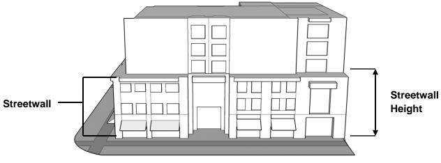
Figure 56: Streetwall and Streetwall Height
