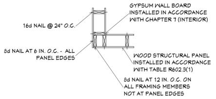
FIGURE R602.10.5 - CORNER FRAMING INSIDE CORNER DETAIL
