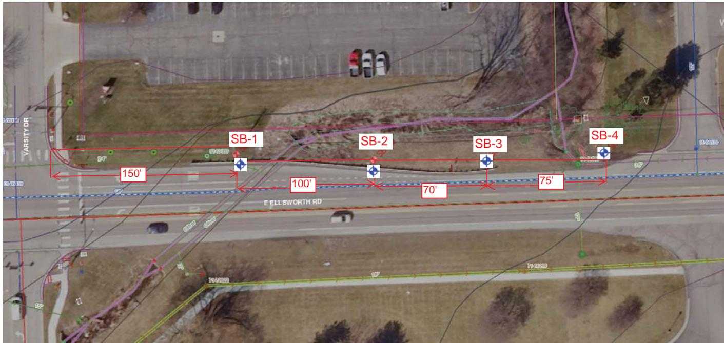
TEST BORING LOCATION PLAN
