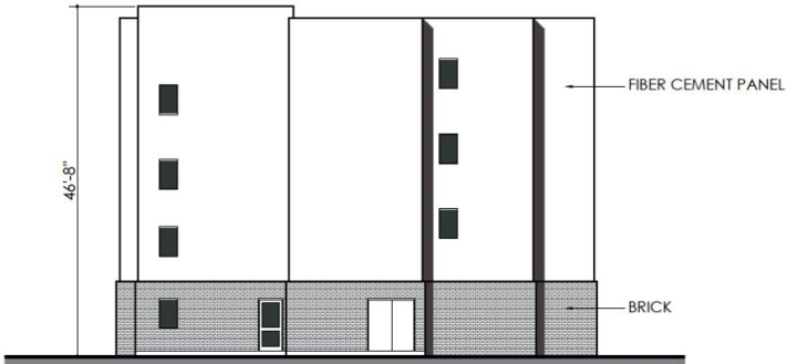
END ELEVATION SCALE: 1/8"=1'-0"
