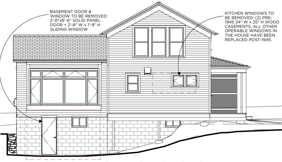
REAR ELEVATION - EXISTING SCALE: 1/8" = 1'-0"
