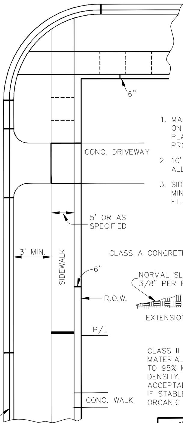
1. MAX. 300' SPACING BETWEEN ALL EXPANSION JOINTS. ON CURB AND GUTTER. EXPANSION JOINTS TO BE PLACED IN SIDEWALKS AT THE EXTENSION OF ALL PROPERTY LINES.
